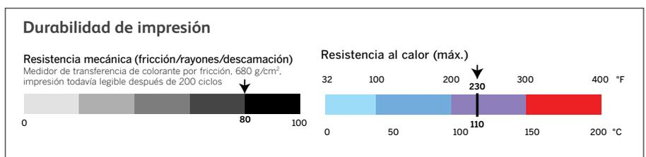
Evaluación de Videojet de rendimiento observado en la cinta Ultra con configuración y receptores optimizados para impresoras.
